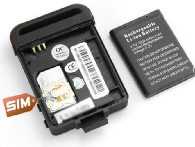
Obrázek 30 Vnitřní stavba GPS lokátoru [72]
