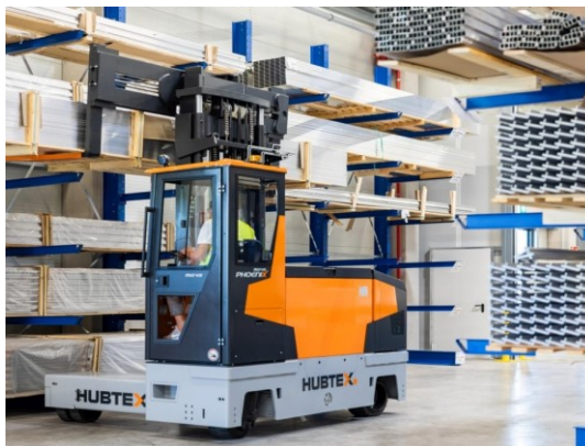
Obrázek 3 VZV s bočním uspořádáním zdvihacího zařízení (HUBTEX, 2024)
