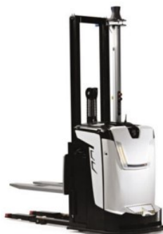
Obrázek 6 Automaticky naváděný vysokozdvížený vozík (Ullrich, 2015)
