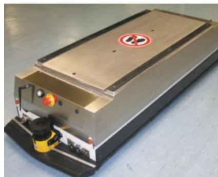
Obrázek 7 Podjezdové AGV (Ullrich, 2015)
