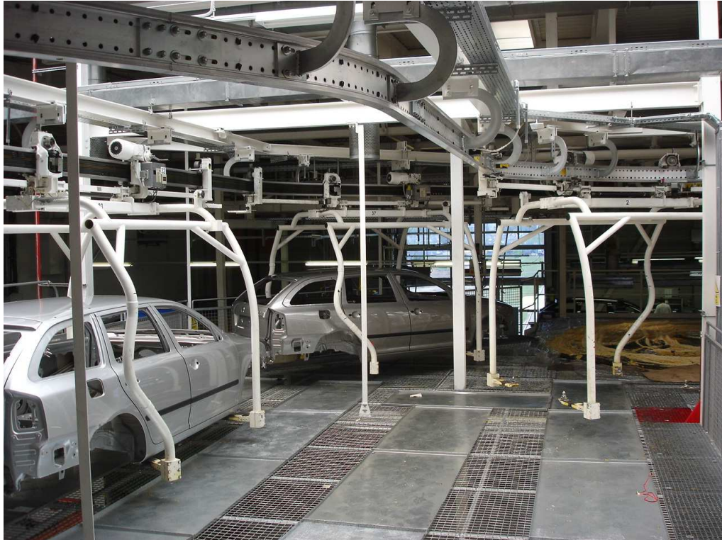
Obr. 1 Místo na dopravní trase pro umístění zvedacího manipulátoru
