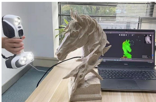
Obr. 23: 3D skenovanie ručným skenerom. 36
