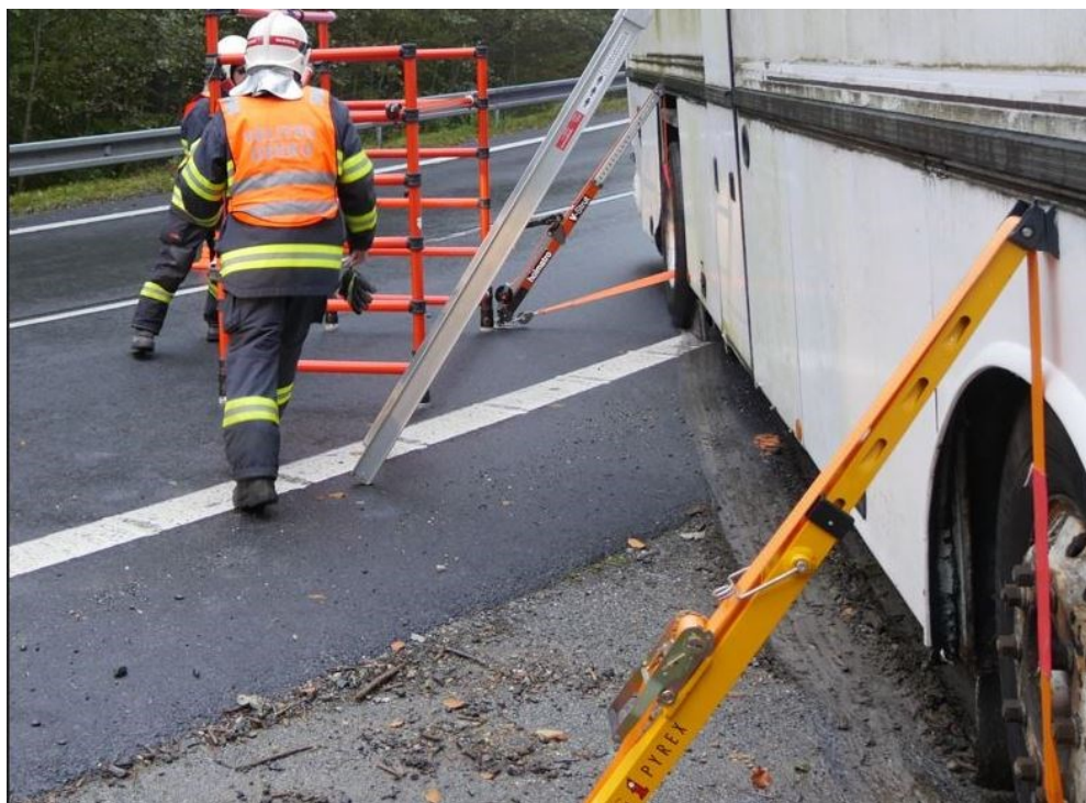
Obrázek 25 Zajištění autobusu pomocí stabilizačních tyčí (zdroj HZS OLK)
