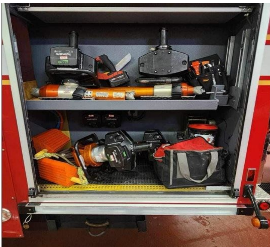
Obrázek 21 Bateriové HVZ Holmatro u TFS (zdroj Rob Klassen )
