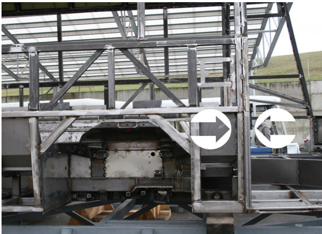
Obrázek 2 Bočnice kostry autobusu (zdroj, SOR Libchavy)
