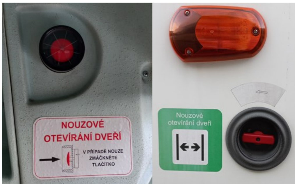
Obrázek 3 Vnitřní a vnější nouzové ovládání dveří (zdroj vlastní)
