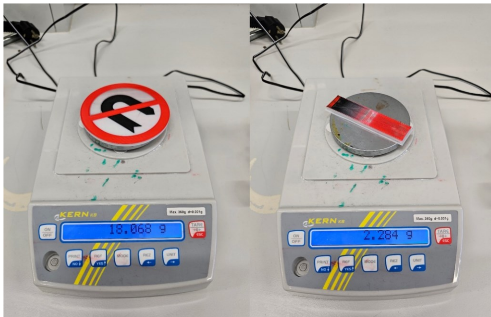
Obrázok 158: Porovnanie hmotnosti výtlaku značky zákaz otáčania (vľavo) s hmotnosťou stieracej veže (vpravo)
