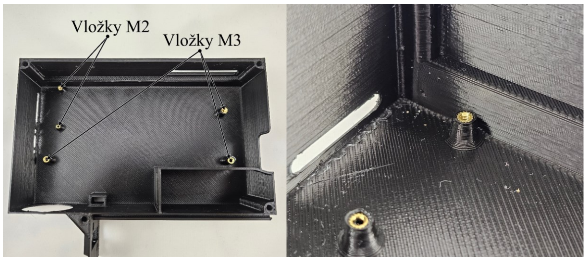
Obrázok 146: Umiestnenie a detail vložených závitových vložiek
