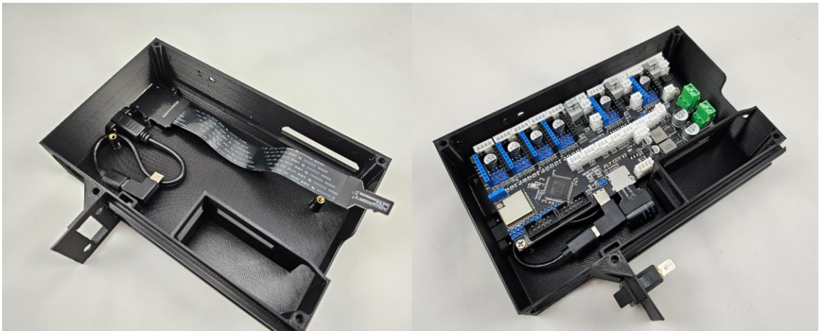
Obrázok 147: Nainštalované predĺžovacie káble v kryte (vľavo) a prichytená ovládací doska (vpravo)
