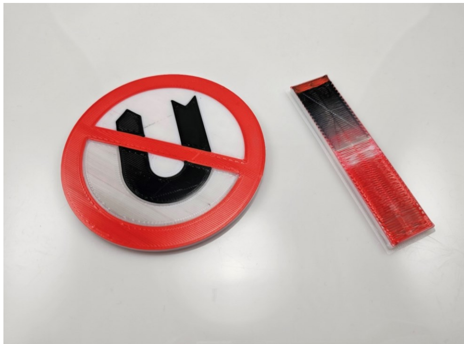
Obrázok 157: Multifarebný výtlak značky zákaz otáčania (vľavo) a príslušnej stieracej veže (vpravo)
