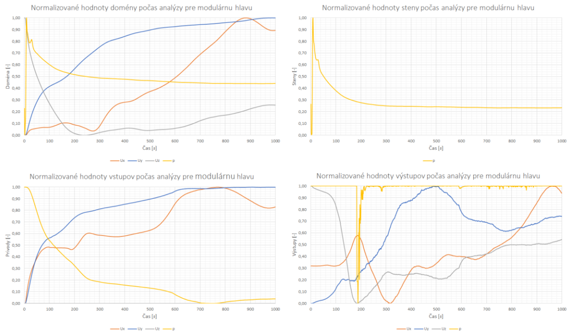
Obrázok 86: Konvergenčné grafy okrajových podmienok pre simuláciu modulárnej hlavy
