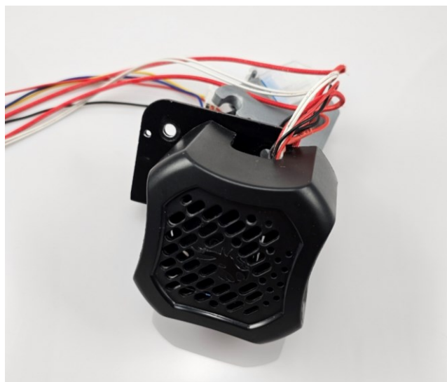
Obrázok 134: Demontovaná originálna hlava 3D tlačiarne Ender 3 V2
