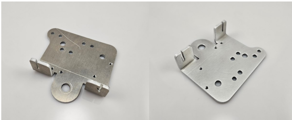
Obrázok 138: Držiak pred brúsením (vľavo) a po brúsení (vpravo) brúsny rúnom
