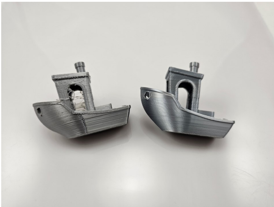
Obrázok 154: Porovnanie kvality modelu loďky „Benchy“ vytlačenom na originálnom dizajne (vľavo) a na modifikovanom dizajne (vpravo)
