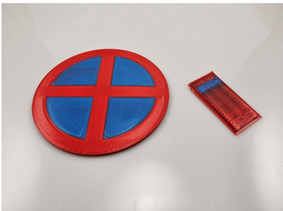
Obrázok 155: Multifarebný výtlačok značky zákaz zastavenia (vľavo) a príslušnej stieracej veže (vpravo)
