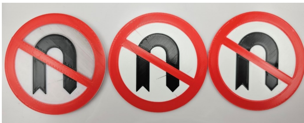
Obrázok 159: Prvá verzia s východiskovými nastaveniami (vľavo), verzia s vyšším stieracím objemom (v strede) a verzia so skokom Z (vpravo)
