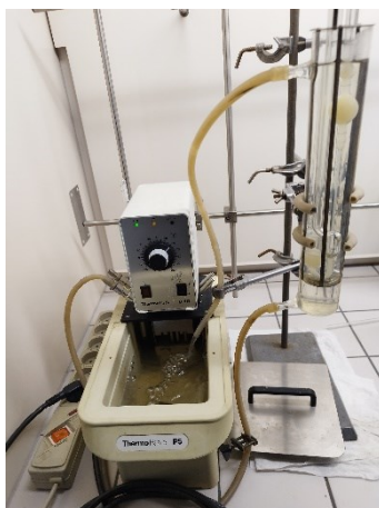
Obrázek č. 17: Přístroj Thermo Haake a Ubbelohdeho viskozimetr pro měření vizkozity
