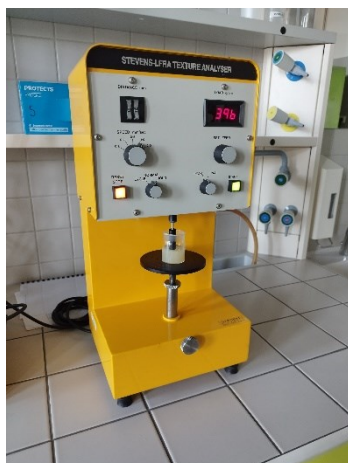
Obrázek č. 16: Stevens-LFRA Texture Analyser pro měření pevnosti gelu
