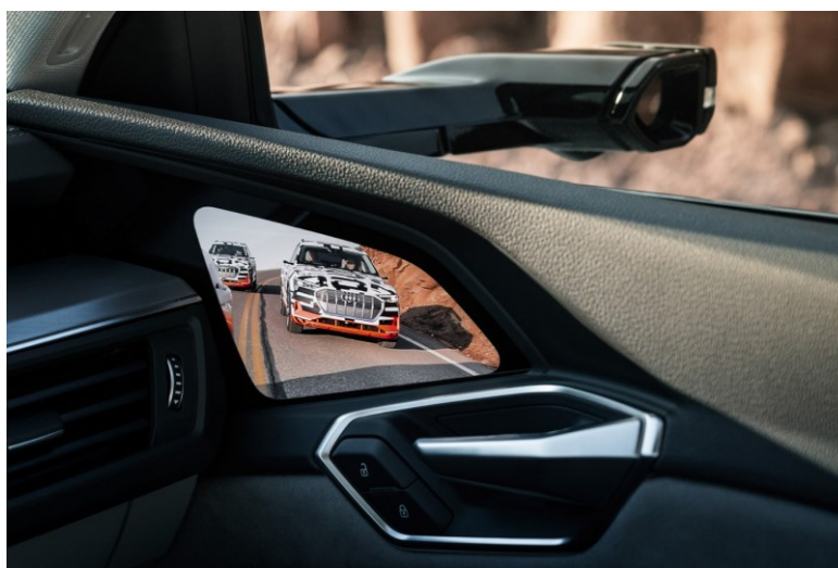
Obrázek 15: Digitální kamerové zrcátka s kamerou [19]
