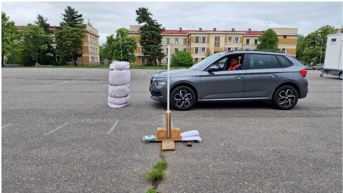
Obrázek 28: Testování brzdění a systému front Assist
