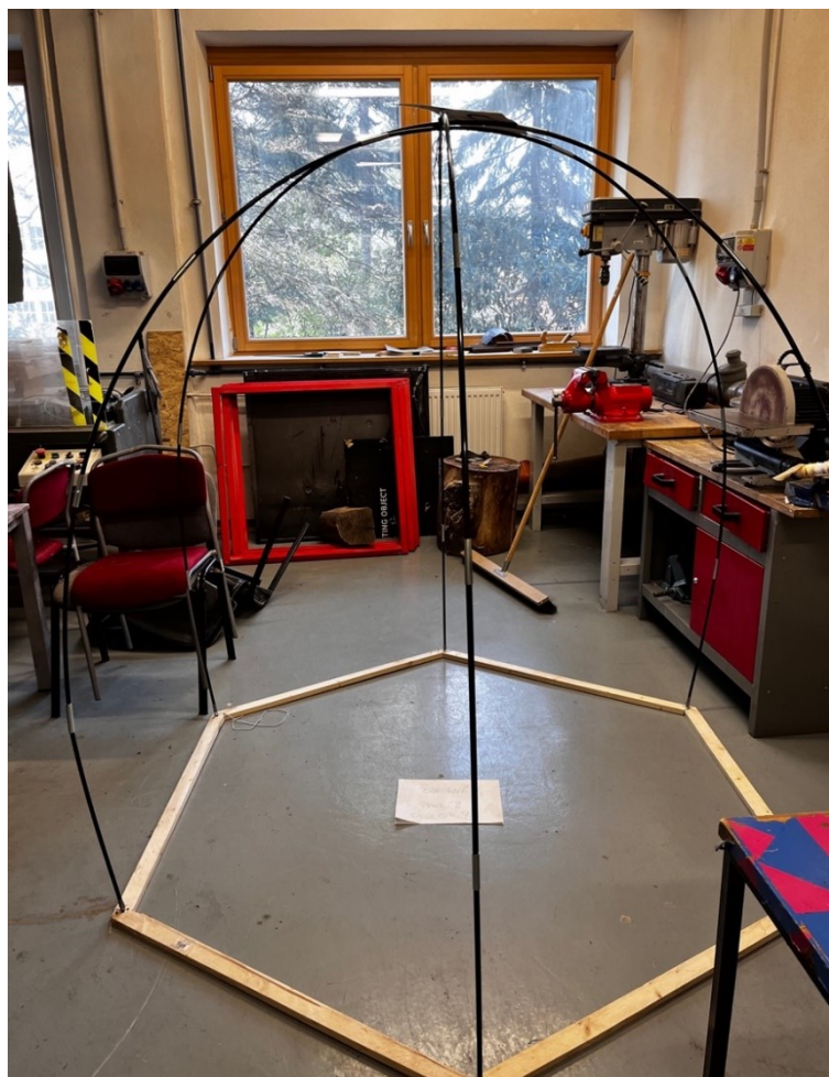
Obrázek 14 - konstrukce ze stanových tyčí a dřevěný podstavec
