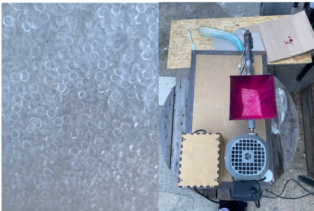
Obrázek 7 Regranulát PS a extrudér (zdroj: archiv autora, 2024)
