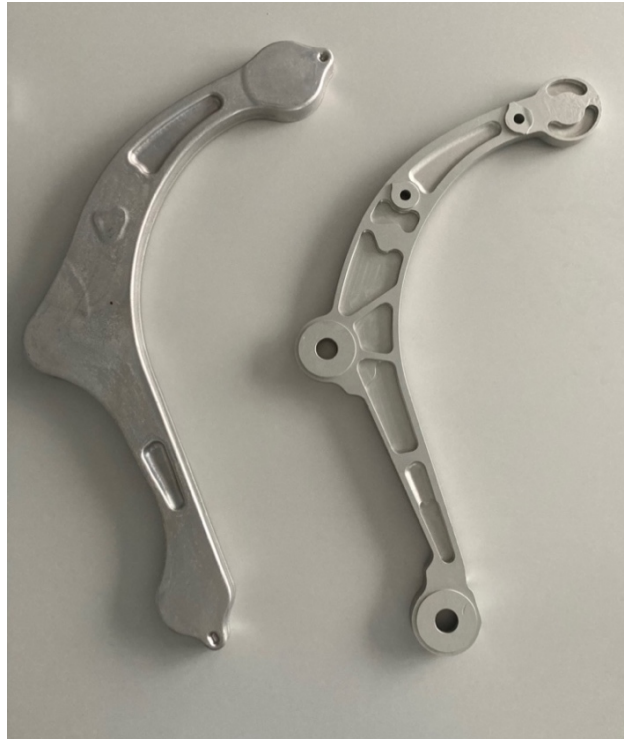
Obrázok 9 Diel RECARO pred frézovaním a po frézovaní (vlastné spracovanie)
