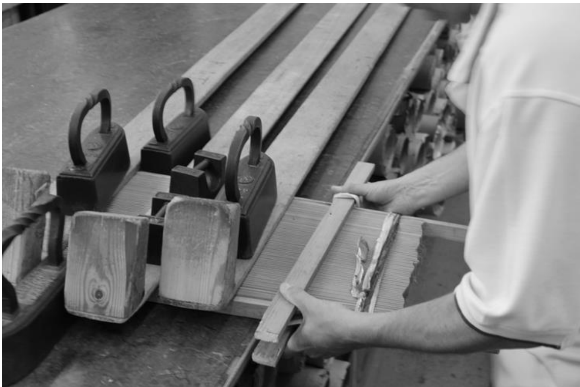
Obr.7: Upevnění složené formy, zajištění proti posunu, stojaté plisé (Ciment pleating)
