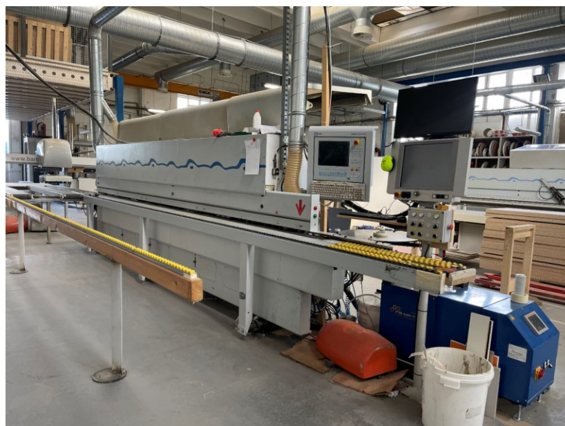
Obrázek 7 Olepovačka hran (zdroj vlastní)
