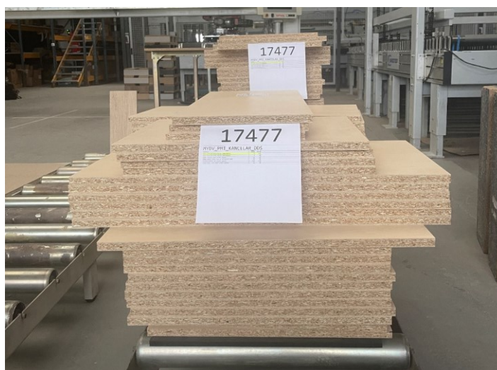
Obrázek 18 Označení palet štítkem (zdroj vlastní)
