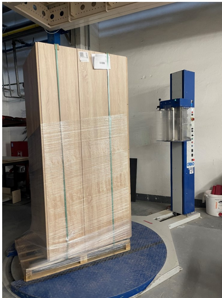
Obrázek 13 Balící centrum (zdroj vlastní)
