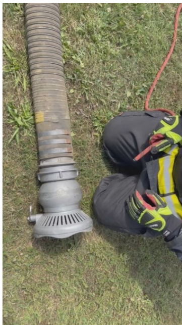
Obr. 54 Úvaz přívodního vedení
