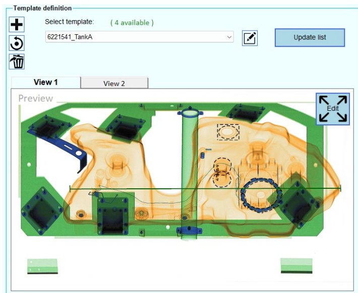
Obrázek 2.8: Definice několika oblastí zájmu (ROI, vyznačené čárkovanou čarou) na vzorové předloze ve vertikálním pohledu (view 1) (zdroj: archiv autora).
