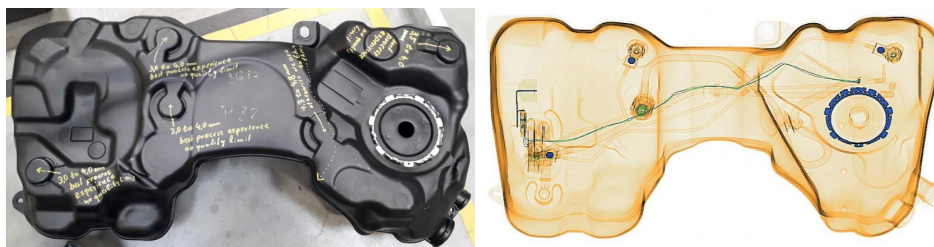
Obrázek 2.6: Palivová nádrž v pohledu shora, vpravo kolorizovaný RTG snímek (zdroj: archiv TI Automotive).
