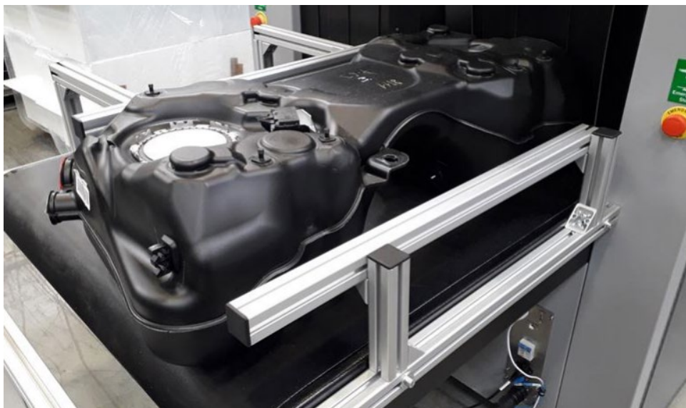
Obrázek 2.7: Palivová nádrž na dopravníku před inspekcí pomocí rentgenu (zdroj: archiv fy TI Fluid Systems).
