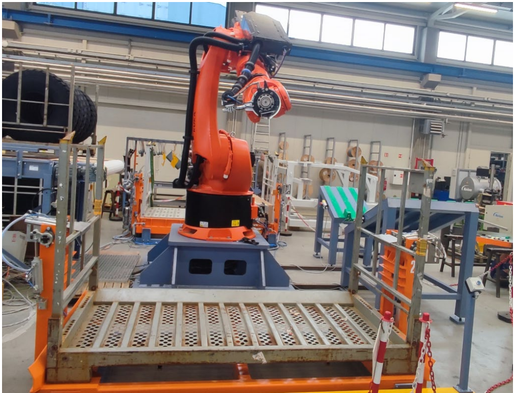
Obrázek 4.17: Šestiosý robot KUKA při testování paletizačního procesu v prostorách firmy Prozax (zdroj: archiv autora).
