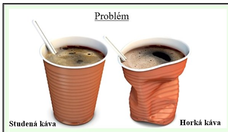
Obr. 1: Kelímky z polymeru PLA (amorfní struktura) – vliv teploty nápoje na jejich tvarovou stabilitu.
