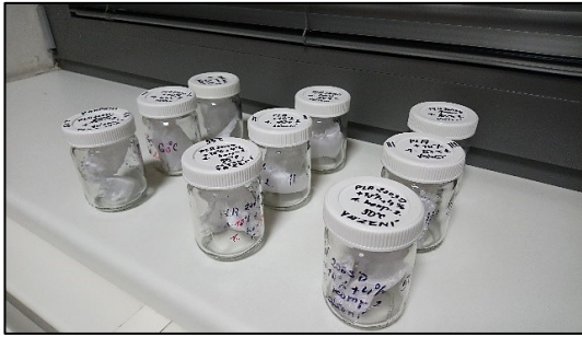
Obr. 11: Skleněné nádoby se vzorky PLA pure a kompozitu PLA + 10 % CaCO 3 a PLA + 10 % CaCO 3 + 4 % PLA/PEG v prostředí deionizované vody – expozice vzorků při hydrolyze.
