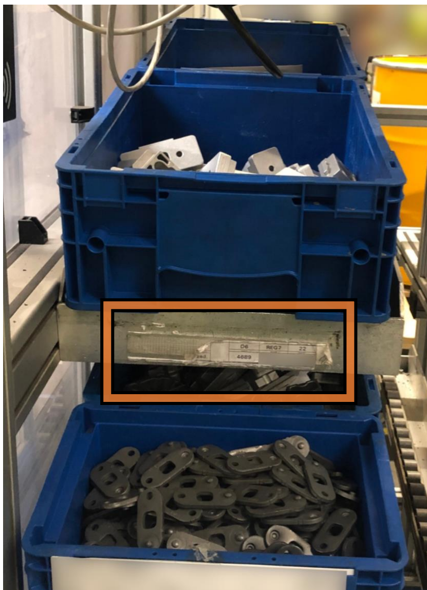
Obrázek 21 Nevhodné značení pozice materiálu na stanici AP1
