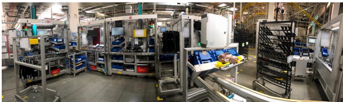
Obrázek 7 Výrobní linka montáže sedadlových kolejnic
