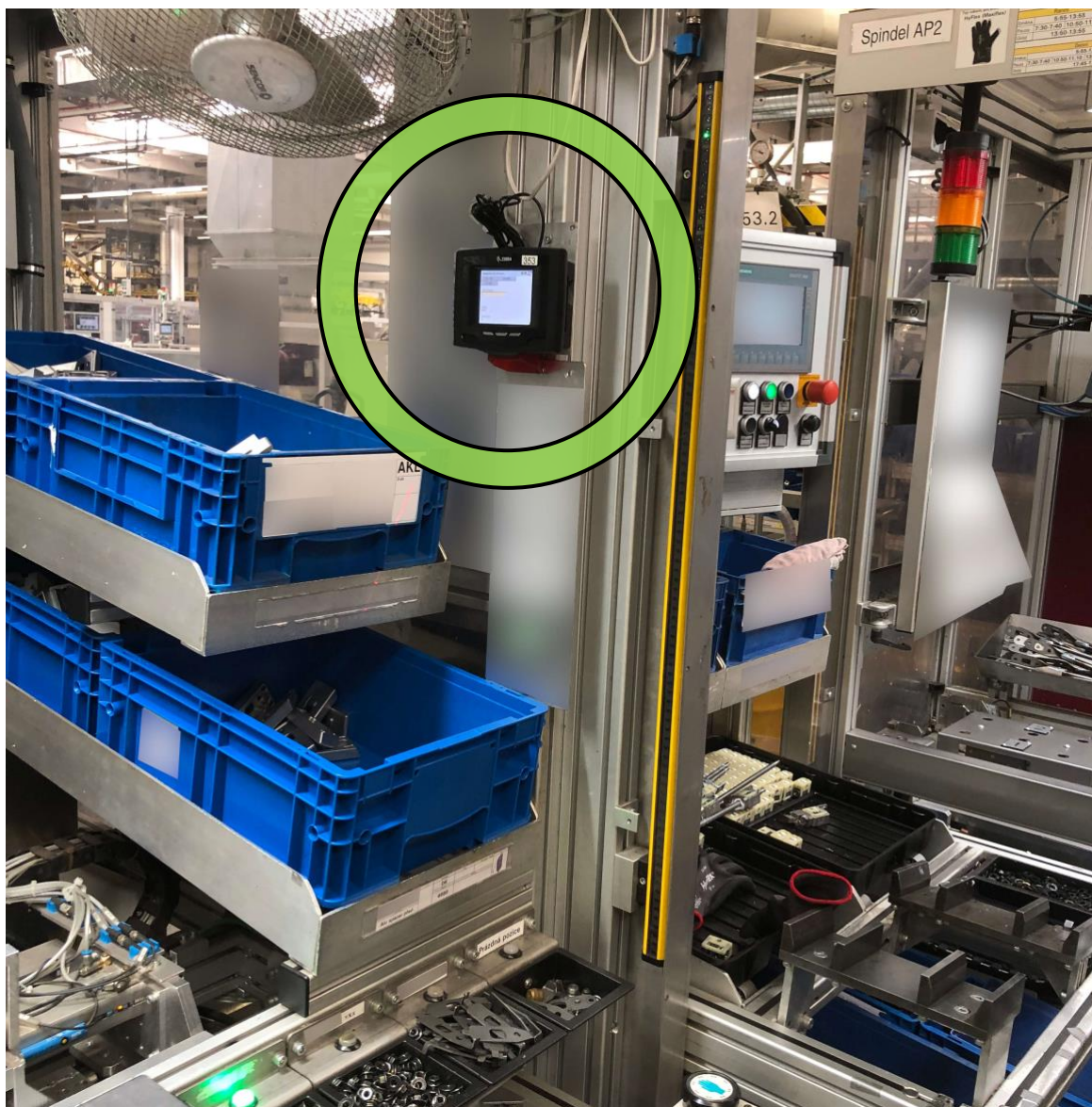
Obrázek 24 Nově implementovaná kanban čtečka na stroji AP3
