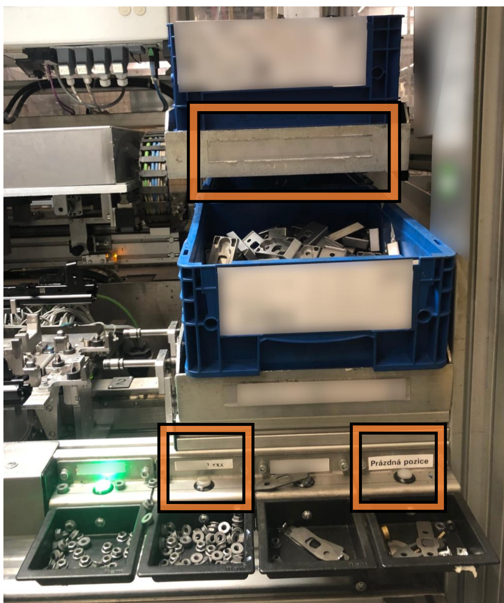
Obrázek 22 Nevhodné značení pozic materiálů na stanici AP3
