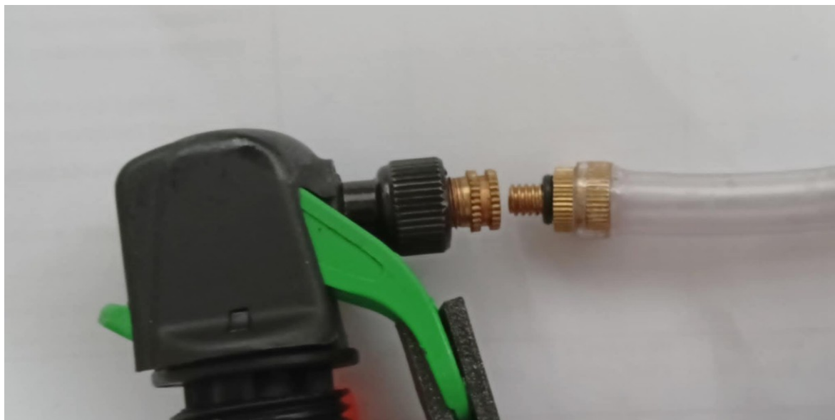
Obrázek 9 Adaptér připevněný k pumpičce a hadičce
