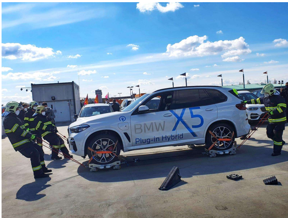
Obrázek 28 Speciální evakuační vozík pro elektromobily [72]
