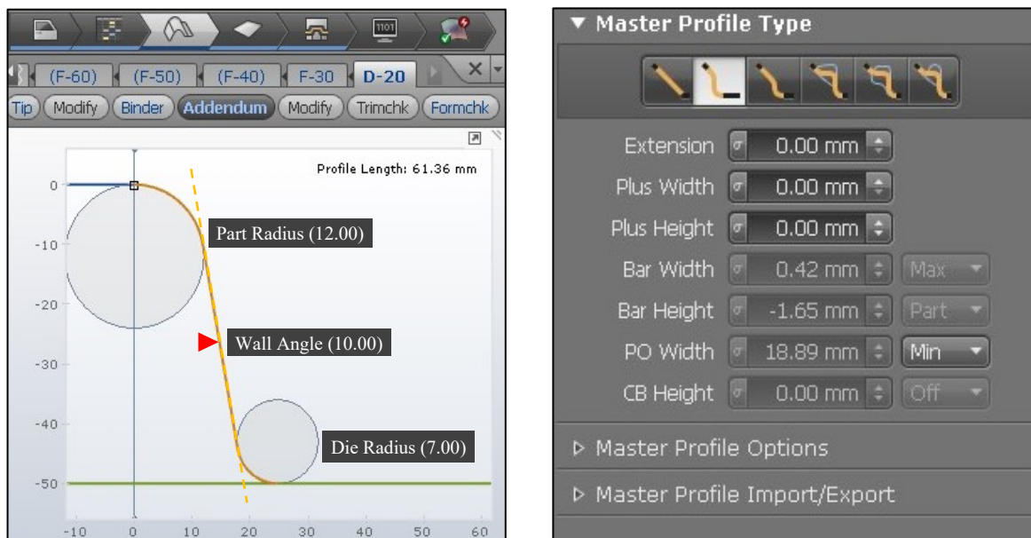
Obrázek 66 Nastavení parametrů přechodového profilu
