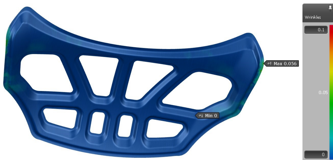
Obrázek 105 Vyhodnocení zvlnění výztužné kapoty
