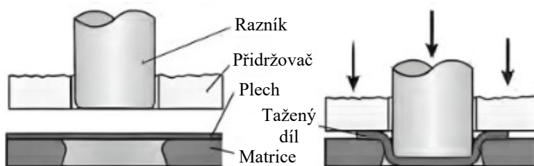
a) Jednoduché tažení s přidržovačem
