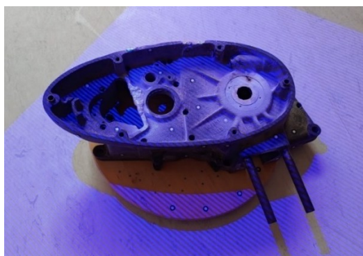
Obrázek 32 Strukturované světlo při snímání skříně
