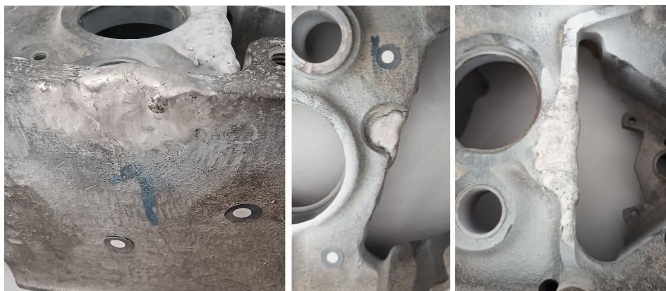
Obrázek 70 Vlevo svar na stěně, vpravo svar uvnitř (seshora a zespoda)
