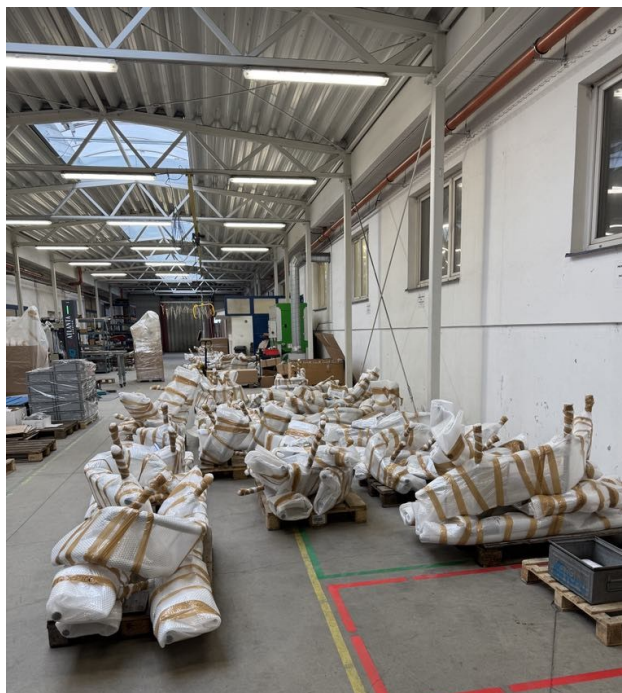
Obrázek 20 Nevhodné uložení zabalených drah ALFA v meziskladu
