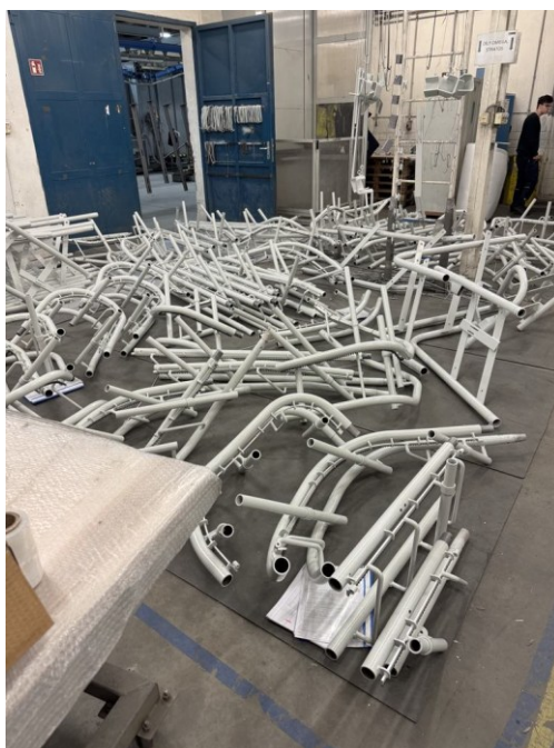
Obrázek 21 Nalakované dráhy umístěné na balírnu/čistírnu
