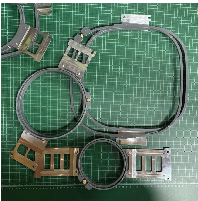
Obrázok 26 Rôzne veľkosti rámov na upnutie textilu. (zdroj: vlastný)
