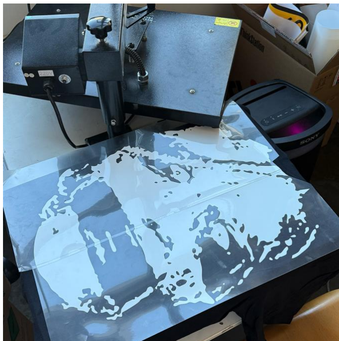
Obrázok 34 Vkladanie trička s fóliou do lisu. Motív zložený z dvoch kusov fólie. (zdroj: vlastný)
