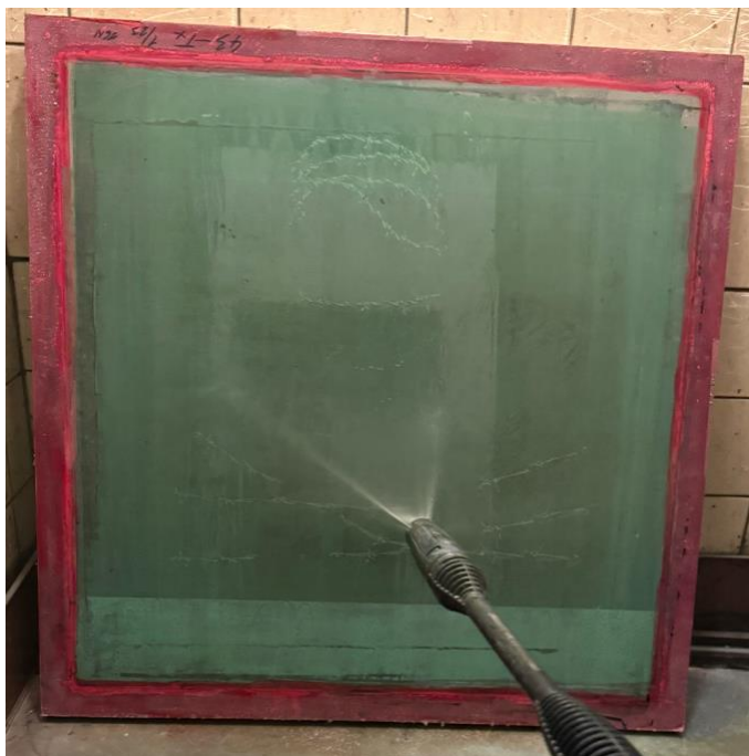
Obrázok 22 Vymývanie nezatvrdnutej emulzie tlakovým čističom. (zdroj: vlastný)
