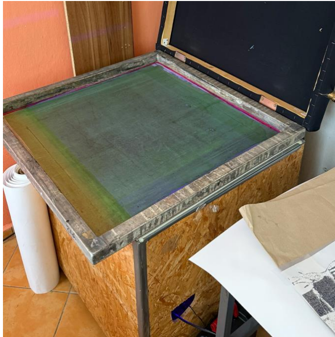
Obrázok 21 Proces nasvietenia sita. V spodnej časti stola sa nachádza silné ultrafialové svetlo, ktoré pôsobí na emulziu. Pod sitom sa nachádza fólia s vytlačenou grafikou. (zdroj: vlastný)
