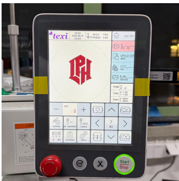
Obrázok 30 Rozhranie ovládania vyšívacieho stroja. Konkrétne Texi 1501 TS. (zdroj: vlastný)
