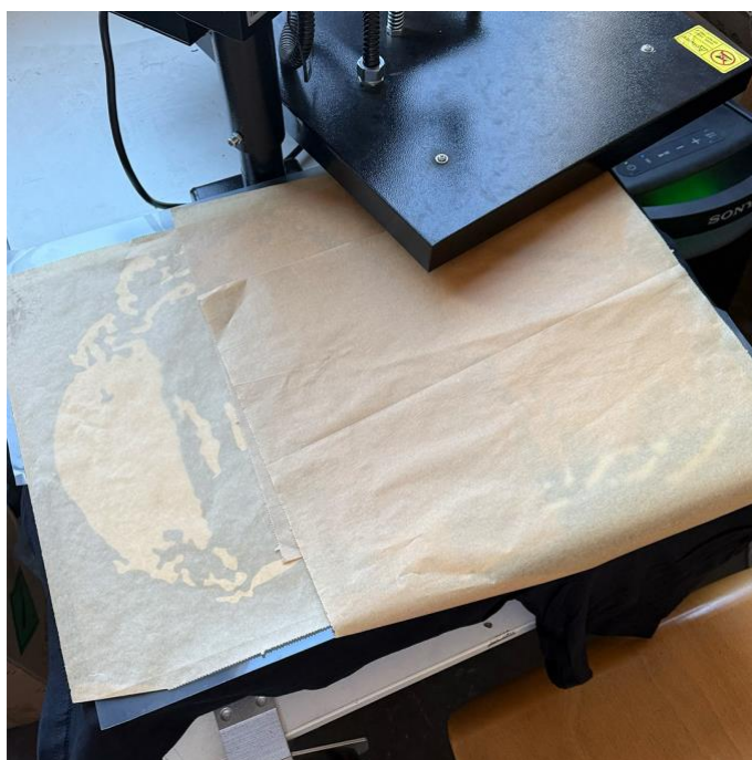
Obrázok 35 Prekrytie papierom na pečenie pred tlačou. (zdroj: vlastný)
