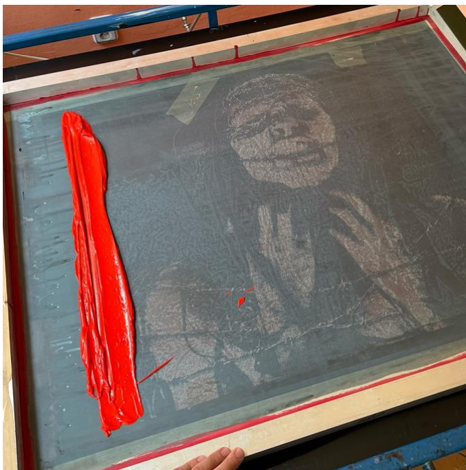
Obrázok 24 Nanesenie farby na sito. Pás sa stierkou natiahne po site (zdroj: vlastný).
