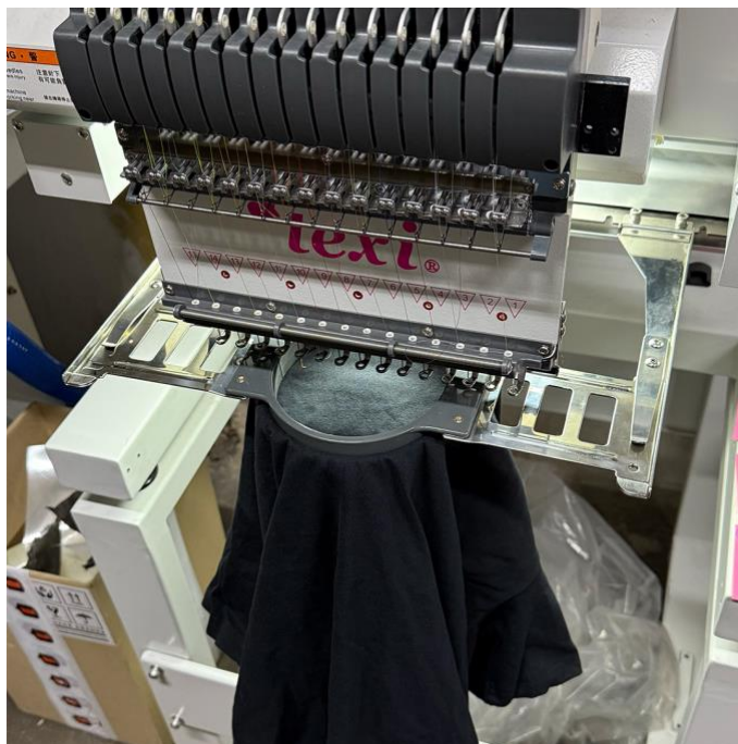
Obrázok 29 Rám uchytý v ramenách vyšívacieho stroja. (zdroj: vlastný)
