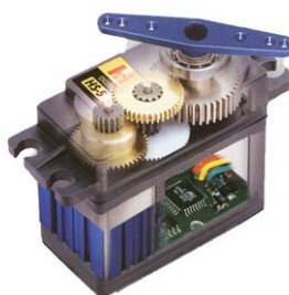
Obr. 7 Ukázka modelářského servomotoru
