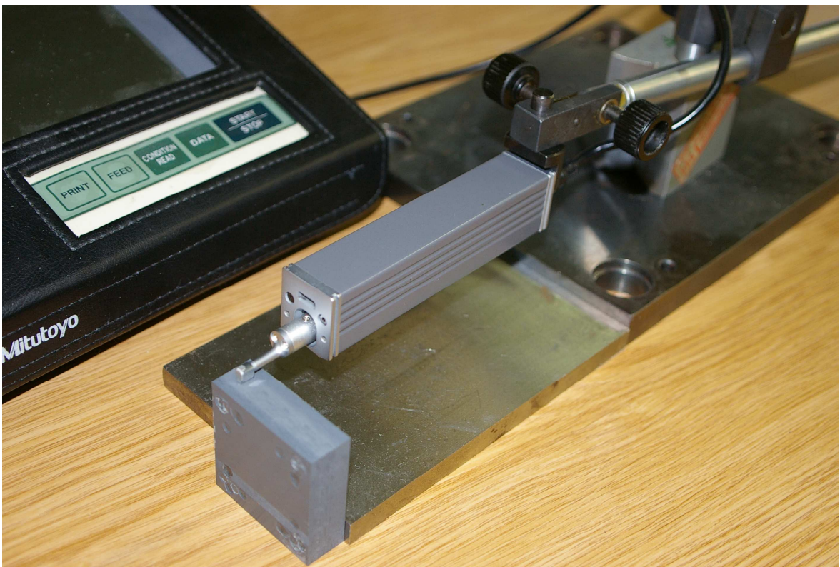
Obr. 32 Detailní záběr při měření drsnosti daného vzorku
