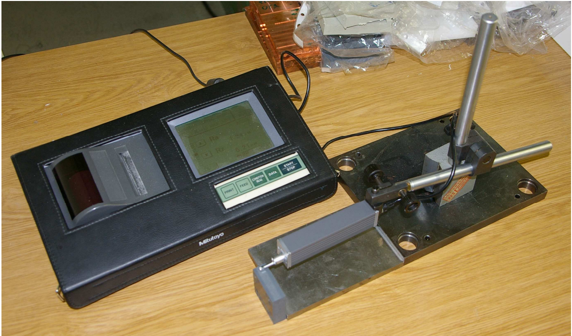
Obr. 32 Detailní záběr při měření drsnosti daného vzorku
