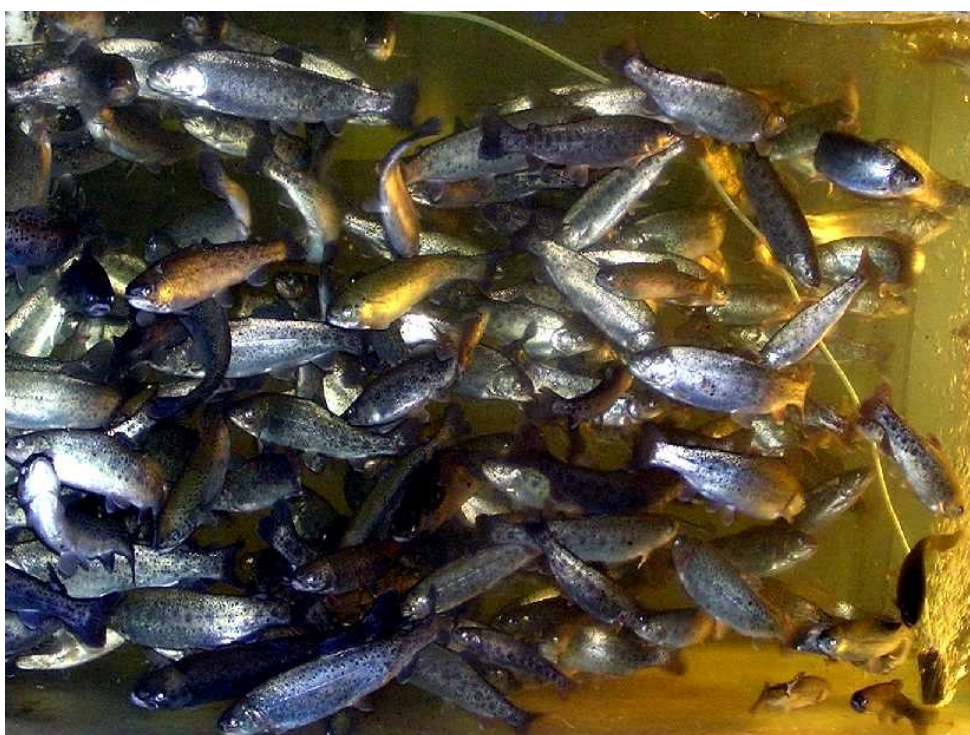
Obr. 1. Pstruzi v akváriu na úpravňě pro rychlé zjištění kontaminace surové vody
