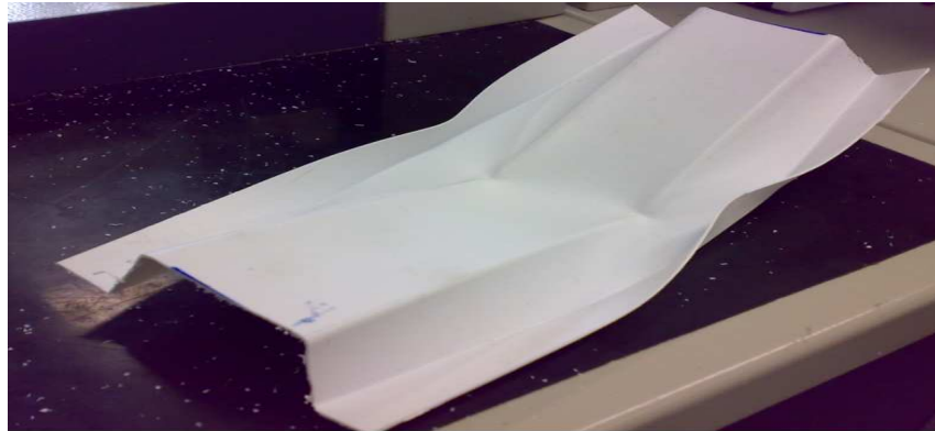
Obr.č 39 Zdeformovaný u-profil výšky 25 mm a tloušťky 1 mm po ohybové zkoušce
