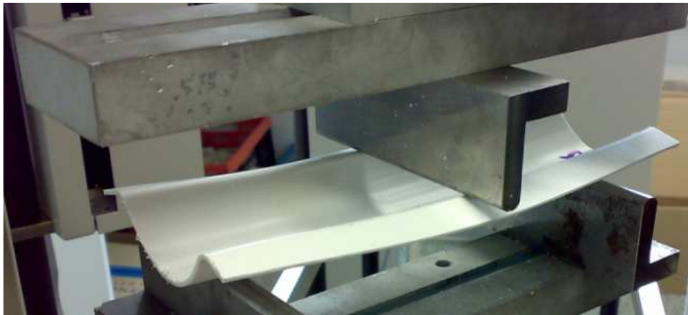
Obr. 51 Foto ohybu profilu se dnem dolů na stroji ZWICK a jeho deformace
