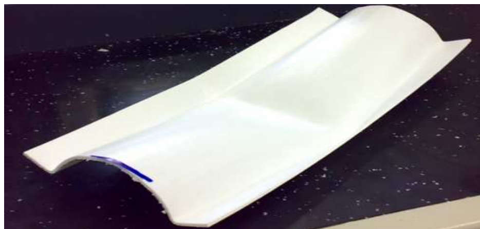
Obr.53 Deformace profilu po ohybové zkoušce se dnem nahoru
