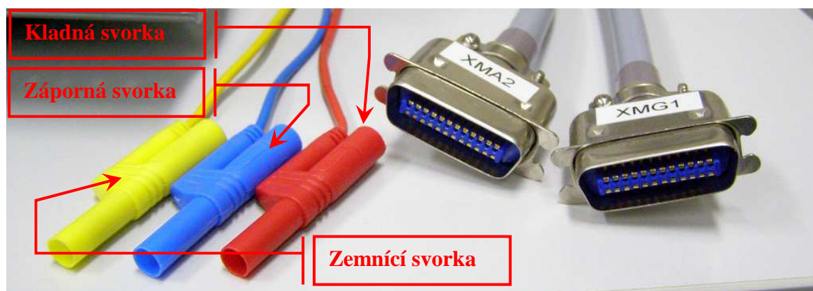
Obrázek 42 – Napájecí kabely PLC Boardu a kabely digitálních vstupů a výstupů
