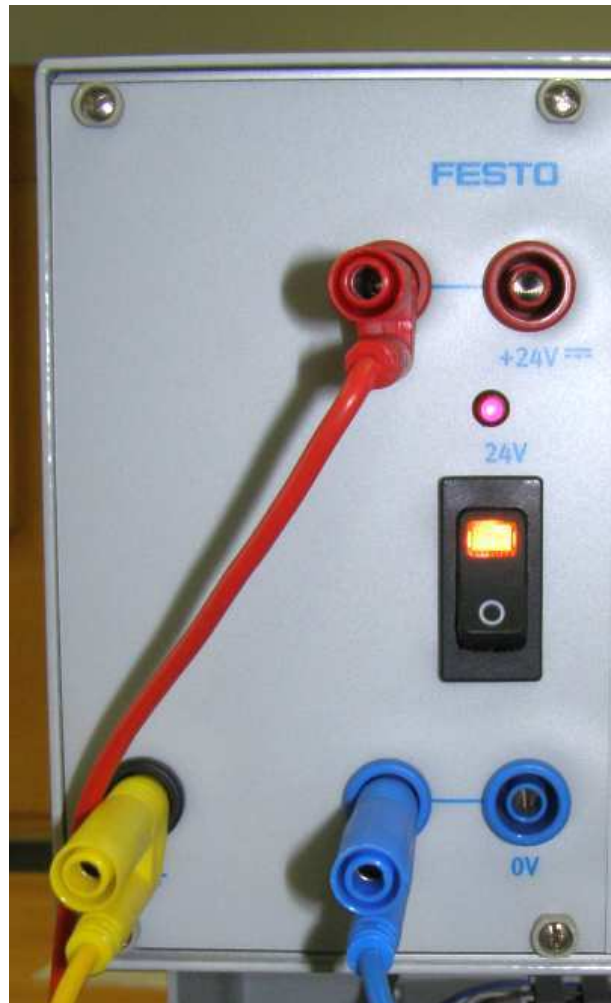
Obrázek 44 – Zdířky pro připojení napájení PLC boardu a hlavní vypínač plnicí linky.
