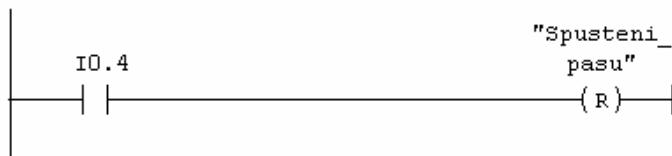
Obrázek 75 – Ukázka pojmenovaných vstupů
