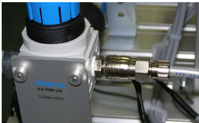
Obrázek 50 – Připojení přívodu vzduchu k regulačnímu ventilu
