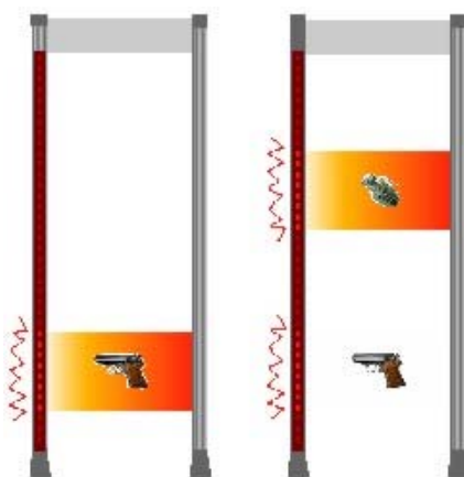
Obr. 3. Schéma principu zónové detekce
