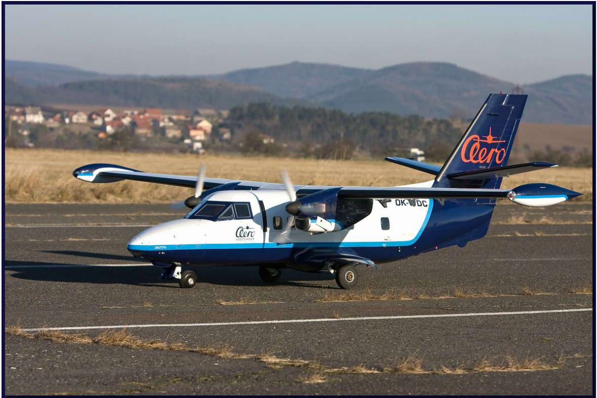
Obr. 19. RC model letounu Let L-410 se zatahovatelným podvozkem předového typu [17]
