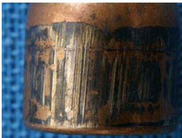
Obr.č. 28. Drážkování střely
