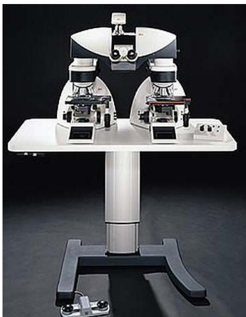
Obr.č. 26 , 27. Komparační mikroskop, snímání střely
