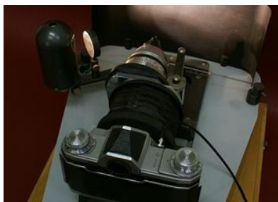
Obr.č. 24, 25. Starší zařízení pro snímání povrchu střely - střelofot.
