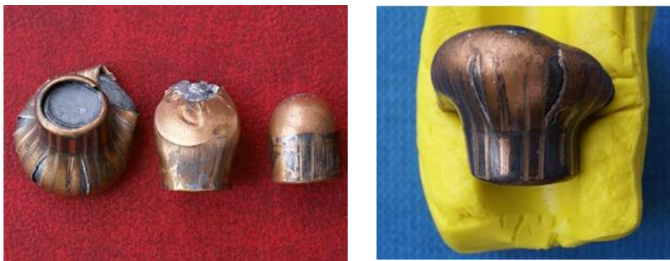
Obr.č. 22, 23. Různé stupně deformace střely
