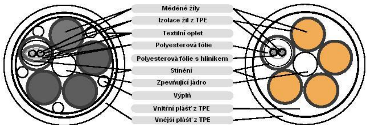
Obr. č. 19: Řez servokabelu
