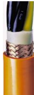
Obr. č. 20 Vzorek A: kabel Chainflex s vnitřním extrudovaným pláštěm.
