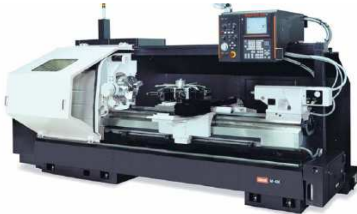
Obr. 3 CNC soustružnické centrum s kluzným vedením na plochem loži pro soustružení dlouhých a velkých dílů [5]
