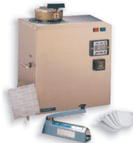
Obr. 17: Přístroj firmy O.K. Servis BioPro ke stanovení vlákniny [74]
