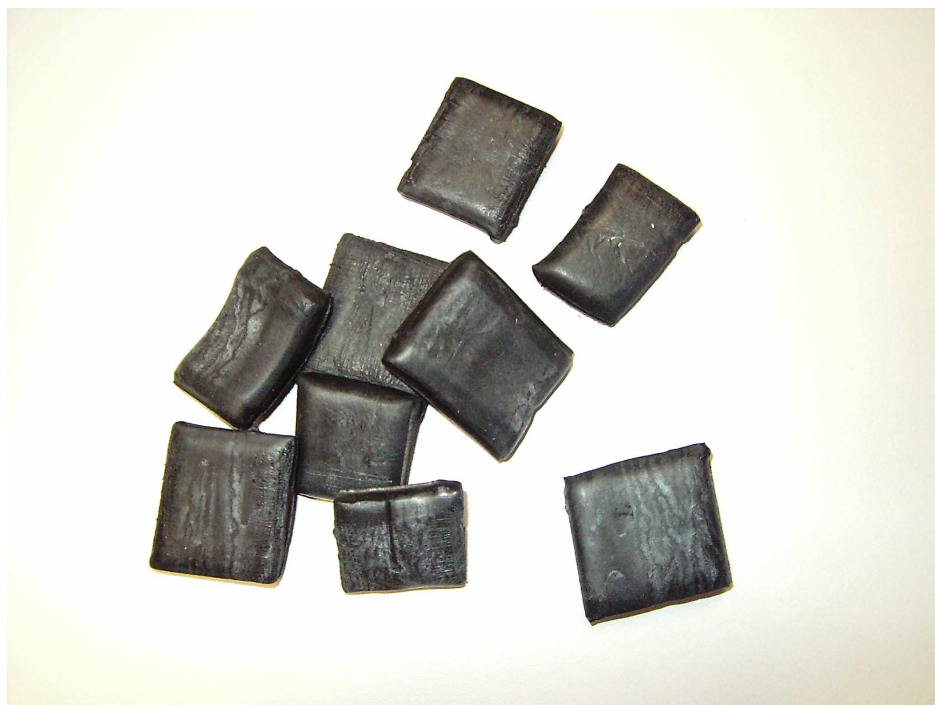
Obr. 17 Nastrihané vzorky zmesi final NR/SR
