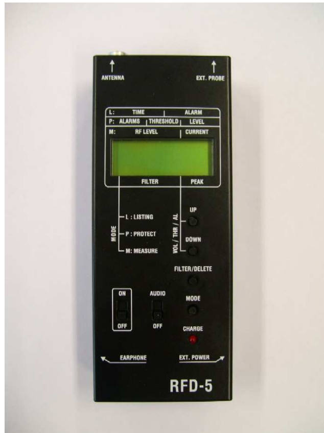
Obr. 6. Detektor vysokofrekvenčního pole RFD-5.
