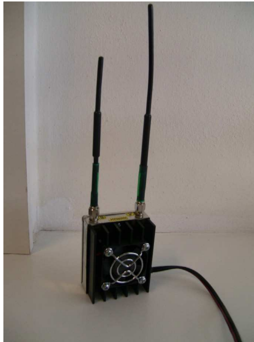
Obr. 3. Duální rušička mobilů GSM-2000 JAM.
