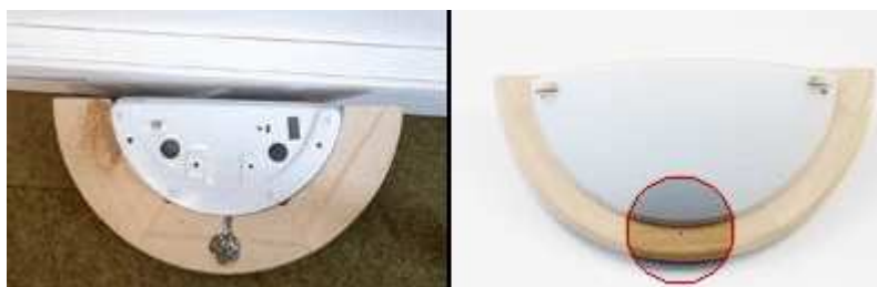
Obr. 13. Instalace kamery v osvětlení [11].
