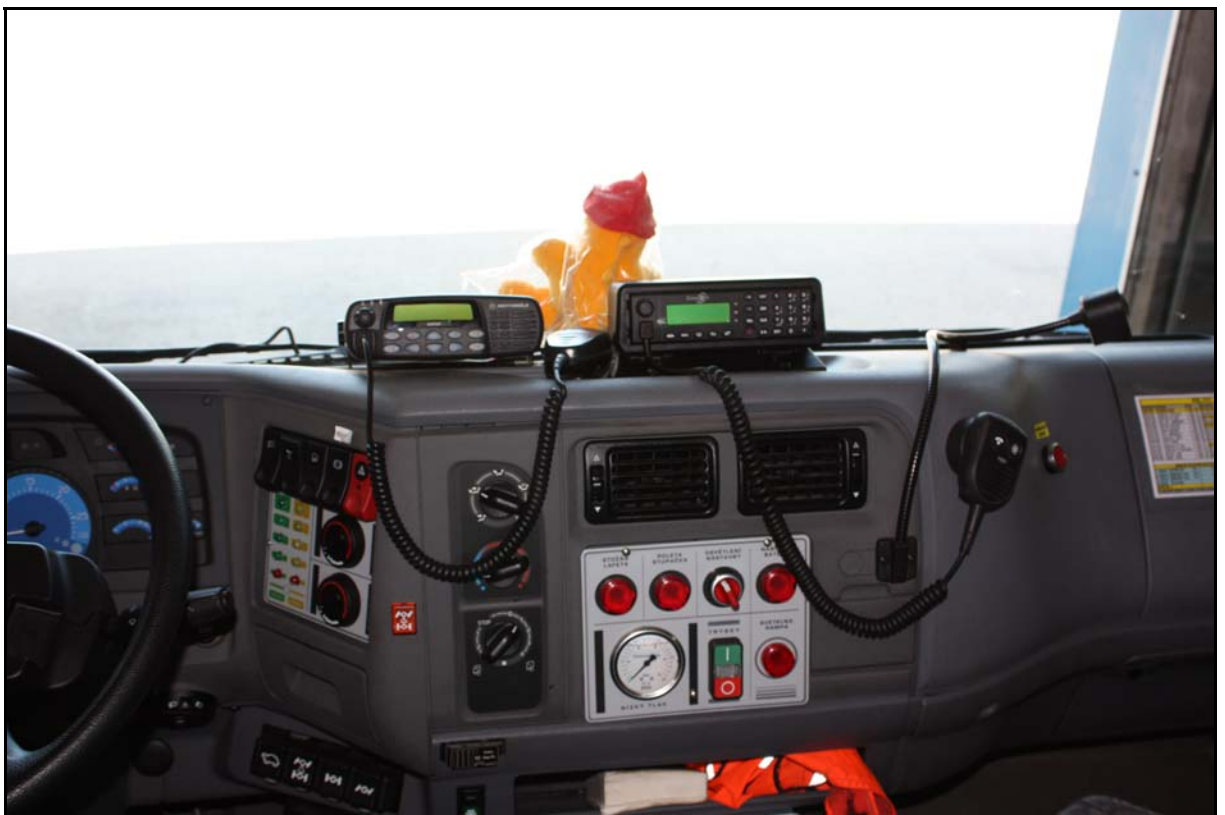
Obrázek 6: Terminál PEGAS-MATRA a SCC ve výjezdovém vozidle CAS
