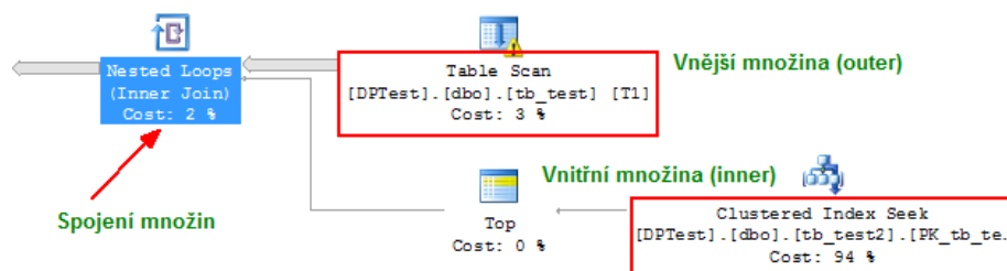
Obrázek 23 – Spojování množin pomocí operace NESTED LOOPS
