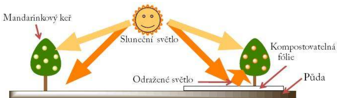
Obrázek 4.: Mechanismus odrazu slunečního světla za použití kompostovací fólie [17]
