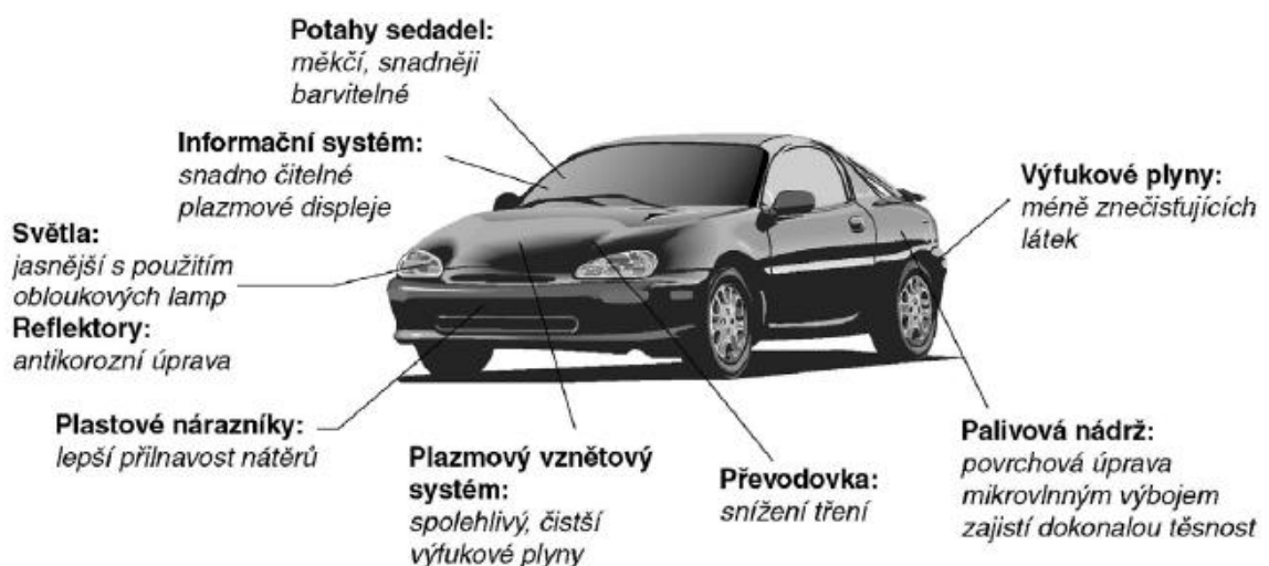
Obr. 22: Přímé nebo nepřímé využití plazmatu při výrobě automobilů [25]
