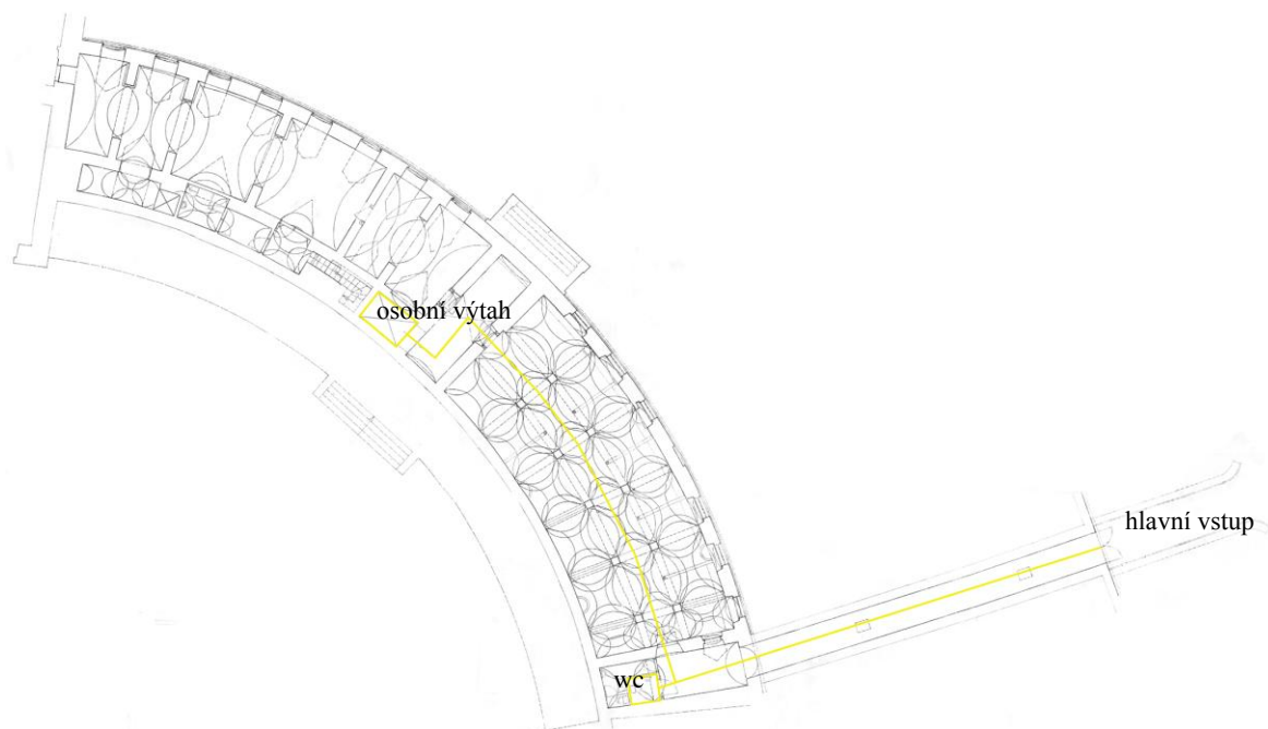
Obr. 75. Schéma bezbariérového přístupu do prostoru konírny.
