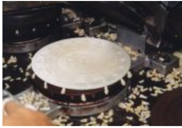
Obr. 6. Kleště na spékacím stroji [26]
