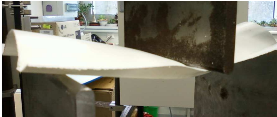
Obr. 85. Ohyb Profilu 3 (1mm) na trhacím stroji Zwick
