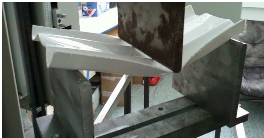
Obr. 86. Ohyb Profilu 1 (1mm) na trhacím stroji Zwick
