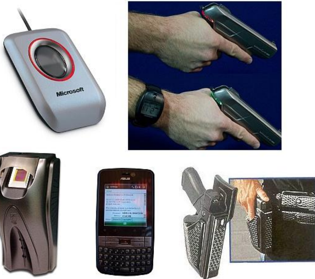
Obr. 22. Vybraná zařízení používající jako ochranu otisk prstu. Zleva doprava je čtečka pro přístup do PC, pistole, čtečka pro přístup do objektu, mobilní telefon, zbraňové pouzdro. [27] [28] [29] [30] [31]
