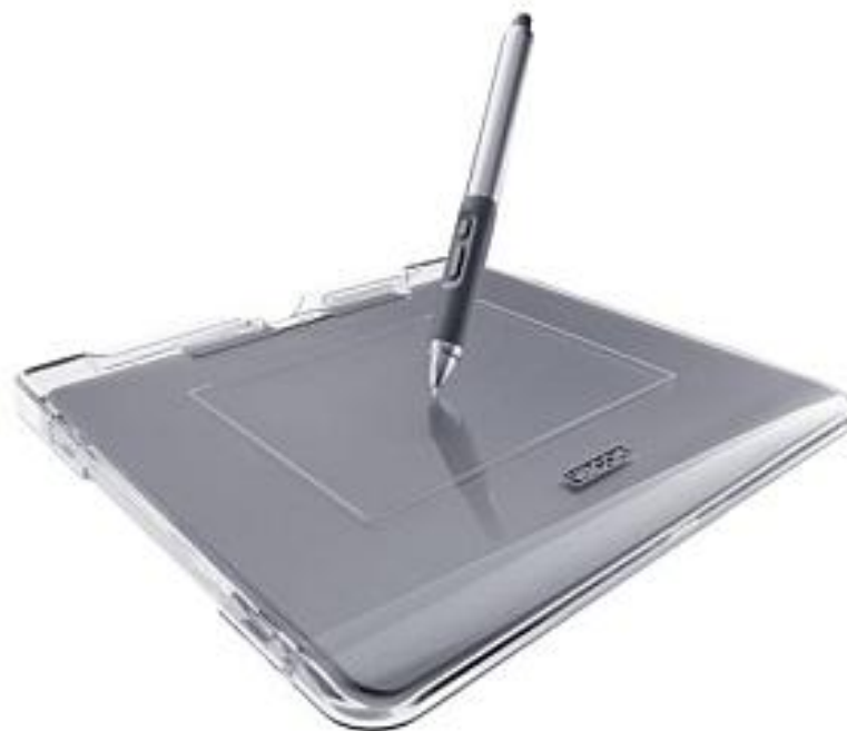
Obr. 44. Ukázka speciálního tabletu pro snímání dynamiky podpisu od firmy Wacom. [45]
