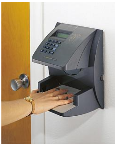
Obr. 32. Systém identifikující podle geometrie ruky od fy Recognition Systems, Inc. [39]
