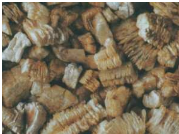
Obr. 9: Exfoliovaný (expandovaný) vermikulit
