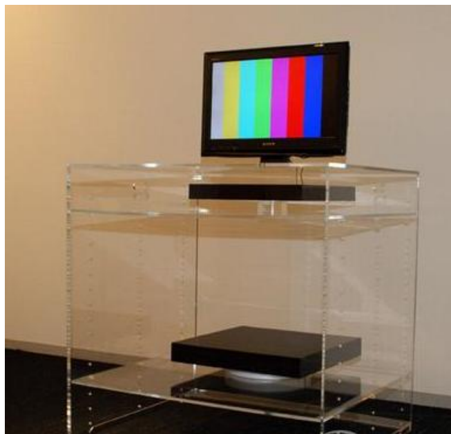
Obr. 14 Bezdrátový přenos energie od Sony [12]
