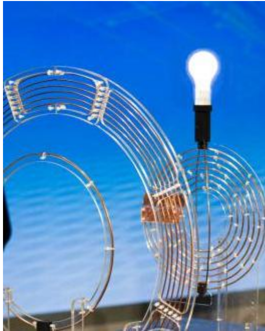
Obr. 7 Výkonový bezdrátový přenos energie [12]
