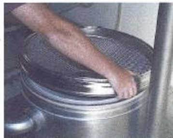
10) Namontujte vložku do filtru Odtud se opakují kroky počínaje bodem 2)
