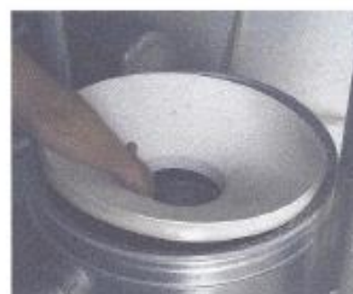
6) Vložte filtrační těleso do podkladové desky
