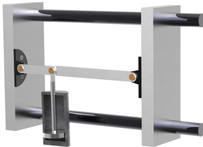
Obr. 12: Uzavírací ústrojí mimo os (uzavřená forma)
