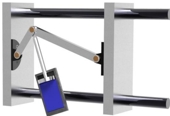
Obr. 13: Uzavírací ústrojí mimo os (otevřená forma)
