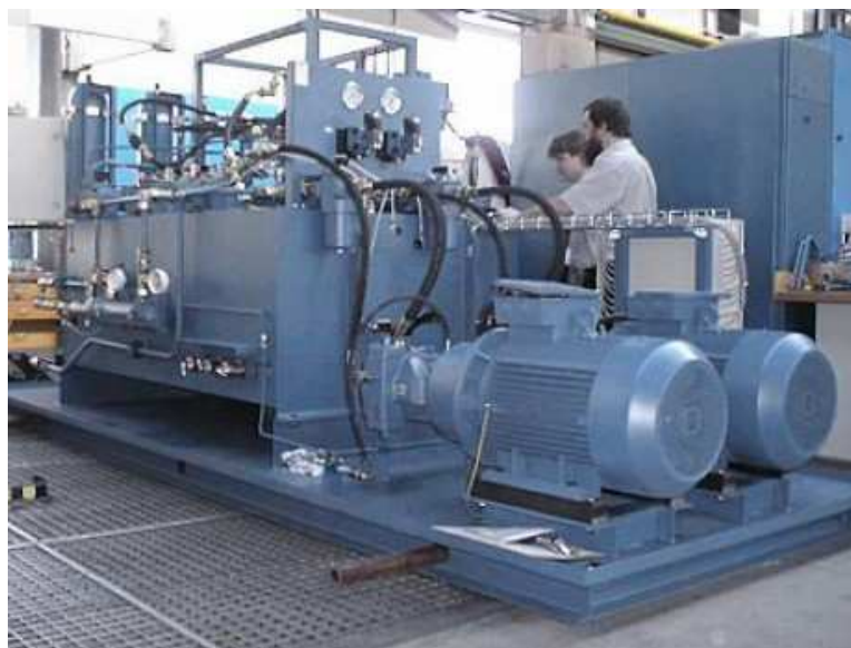
Obr. 16. Hydraulický pohon pro zvedání víka pánve
