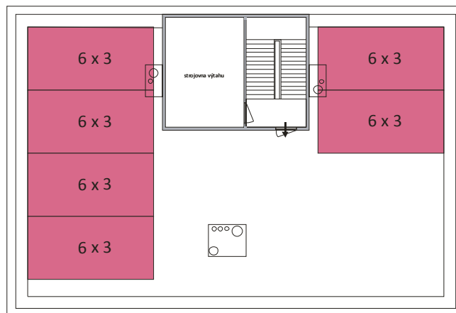
Rozmístění osmi modulů 6 x 3m. Na střeše panelového domu.
